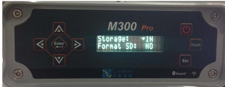
4) 通过上/下方向按键选择“IN”或“EXT”项，然后按一下“Enter”按键，此时存储器选择项的“IN”或“EXT”字符前的倒三角标志变为侧三角标志，再按一下“Enter”按键，侧三角标志消失，表明设置已确认，并保存到接收机内部配置文件，立即生效。若外部未接入U盘或接入存储设备异常，则存储器会自动切换到内部“IN”；
