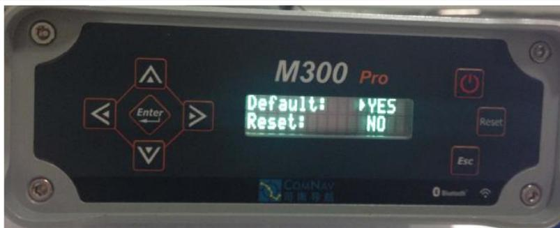
6) 再按一下“Enter”按键，侧三角标志消失，表明设置已确认，M300Pro 会恢复出厂设置并自动重启，重启后出厂设置生效。为保证远程操作能在恢复出厂设置后正常连接接收机，故不更改当前网络设置。
